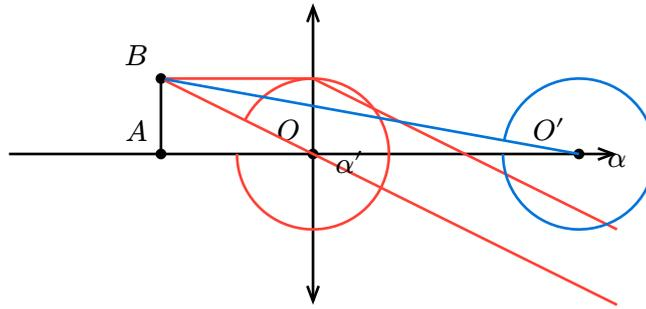
On veut pouvoir observer  $AB$  en étant au repos. Ainsi, il faut que la loupe conjugue  $AB$  par l'infini. On place donc  $AB$  au foyer objet  $F$  de la lentille.
